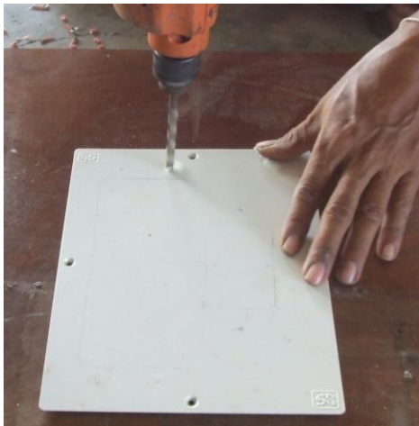
7) เจาะรูบนฝาตรงตำแหน่งที่หมายไว้
